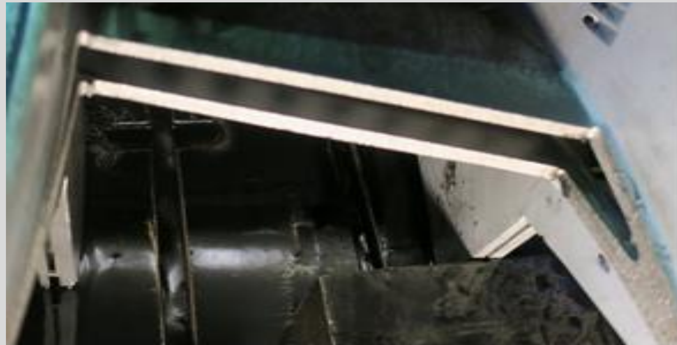
شکل ۳) برش دقیق لبه فرار (TE) و حذف ناحیه تخریب شده
