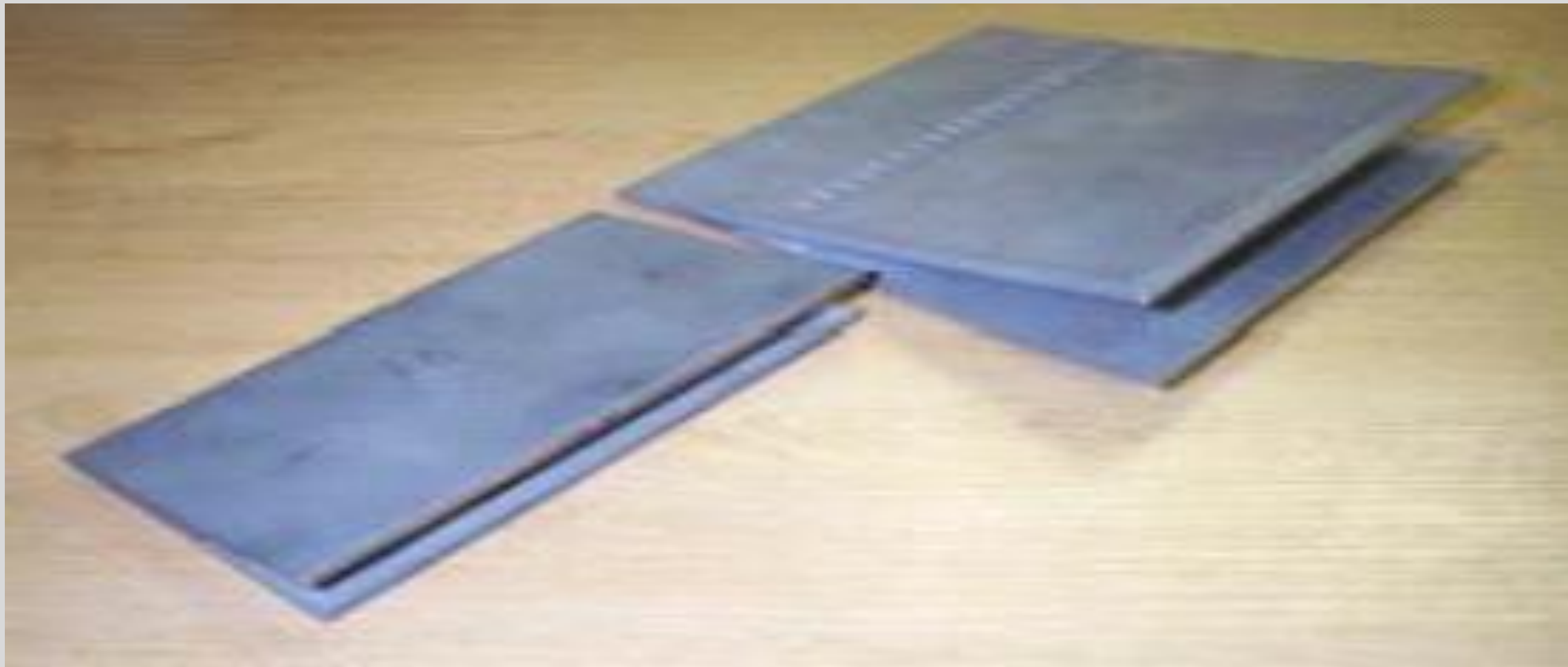
شکل ۲) کوپن های مورد استفاده برای بازسازی نازل ردیف اول GEF9
