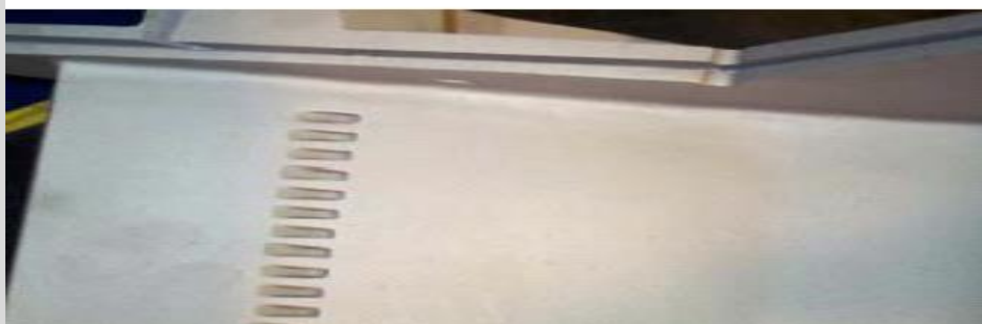
شکل ۵) سطح نهایی بدست آمده پس از بریزینگ و سنگ زنی
